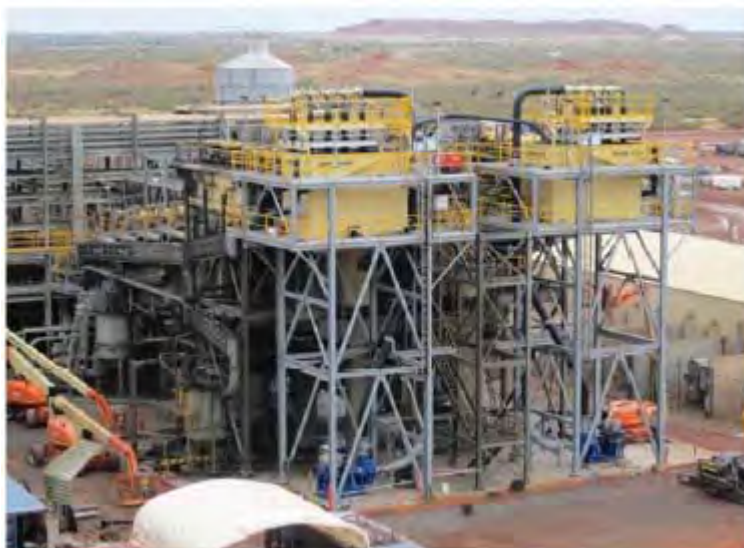
Рис. 4. Фотография флотомашин Джеймсон (скальпирование перед перечисткой) на обогатительной фабрике Телфер
