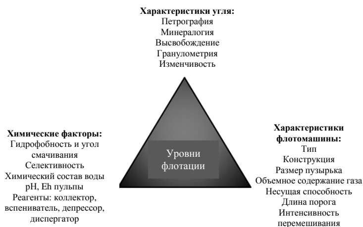
Рисунок 9. Треугольник флотации, изображающий факторы, влияющие на эффективность
