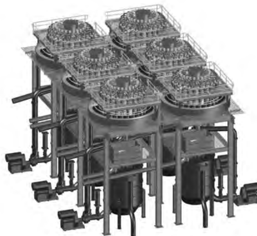
Рисунок 10. Схема установки шести флотомашин Джеймсон модели B6500/24 (занимаемая площадь 22 x 26 м; высота 17 м)
