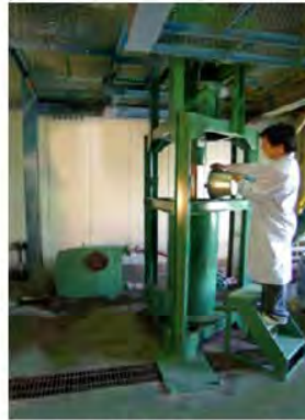
Model 型号 : KM-5 Tower Mill Capacity 容积 : 120 liter Sample 样品 : ~150 kg / test Test period 实验时间 : 2 weeks Purpose 目的 : Mill size selection for the performance warranty 设备选型实验
