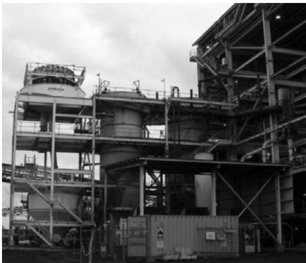
Рисунок 8. Недавно установленная флотомашина Джеймсон (слева) и две колонные флотомашины на предприятии Джерман Крик компании ААМС
