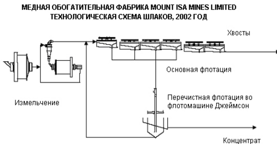
Рисунок 15. Технологическая схема цикла переработки медных шлаков на обогатительной фабрике
