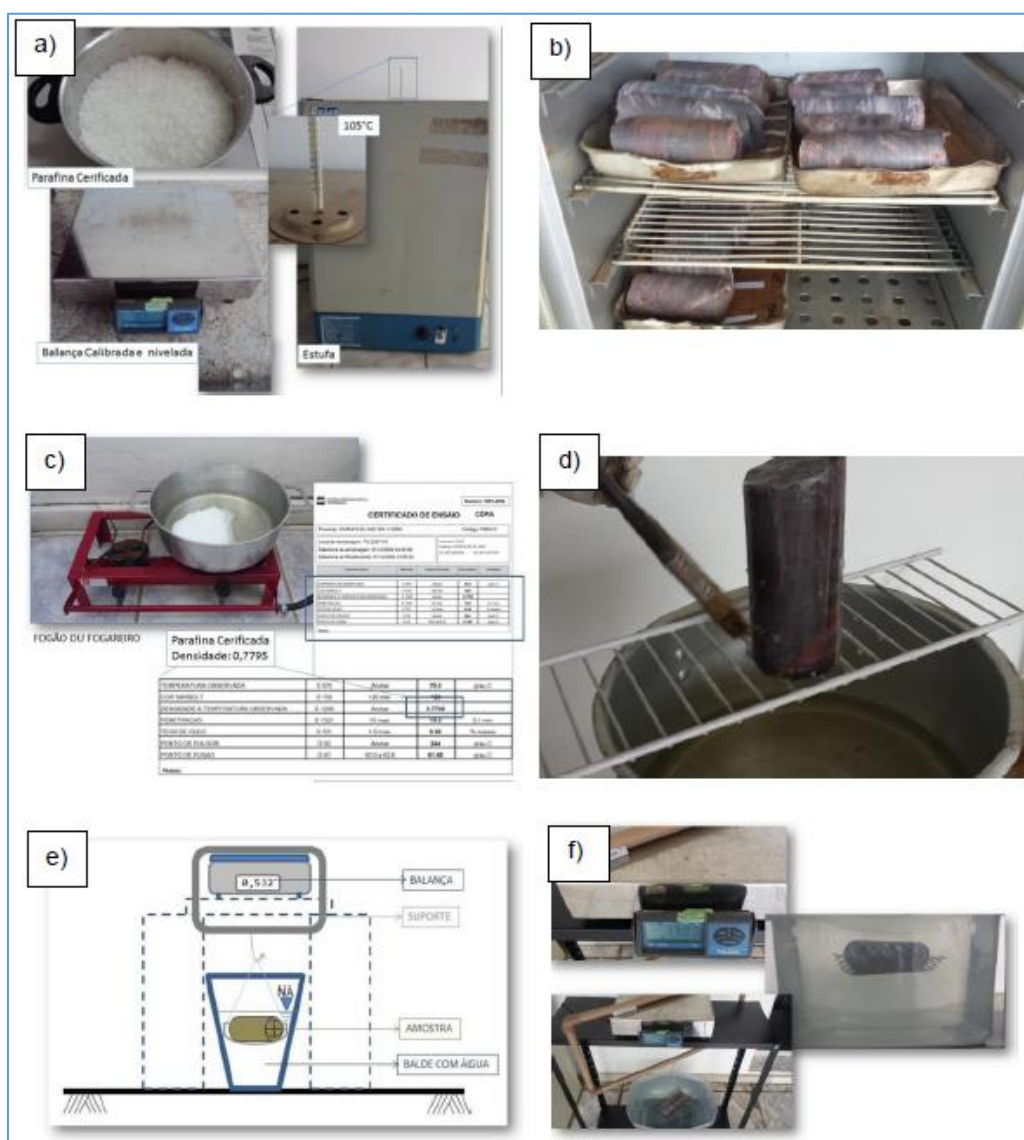
Figura 3.2: Procedimentos de ensaios de densidade: a) materiais necessários (parafina certificada, balança calibrada/nivelada e estufa na temperatura); b) secagem em estufa; c) parafina certificada; d) selagem das amostras com parafina; e) esquema de pesagem das amostras seladas em água; f) pesagem das amostras seladas em água
